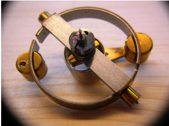
Ovenfor ses urets balance og spiral
