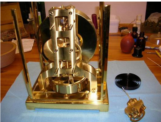
Her er kassen og fjederværket samlet. Den gamle fjeder og gangværket ligger til venstre.
